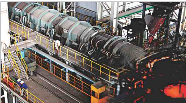
Hệ thống nạp nhiên liệu liên tục Consteel®
